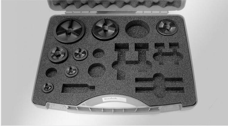
Diese Blechlocher für Edelstahl oder Stahlblech, Aluminium und Kunststoff spalte das Abfallstück je nach Typ in mehrere Teile. Auf diese Weise wird das Festklemmen der Abfallstücke an der Hydraulikschraube und in der Matrize verhindert. Für Hand- und Hydraulikbetrieb.
